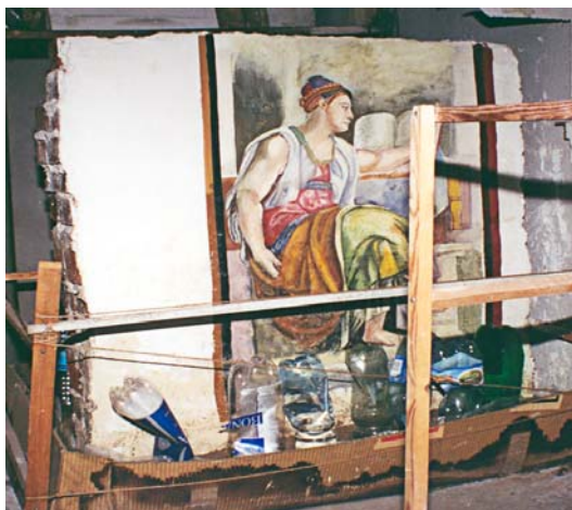
Fot. 5. Model imitujący malowidła ściennie w technice występującej w Polsce poddany kapilarnemu zawilgacaniu (fot. Solida Lim).
